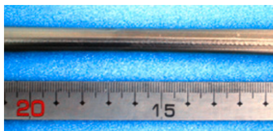
NAS H840のプラズマ溶接パイプ30%引張試験
