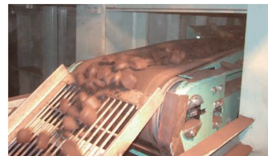
製団機で製作したブリケット
