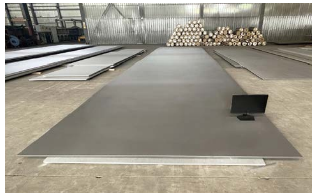
NAS625製品(厚さ15mm×幅3100mm) (モニターは大きさ比較のために置いたものです)
