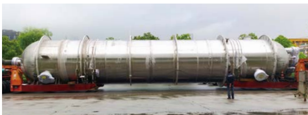
太陽光発電用多結晶シリコン製造装置 江蘇中聖圧力容器裝備製造有限公司様 提供
