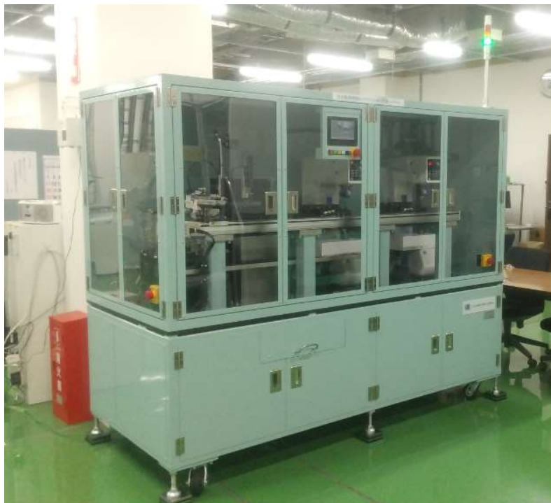
「自動ロックウェル硬さ試験機」（安全上、スチールフレーム・ガラス扉で囲まれています）
