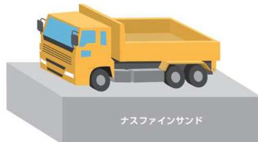
ナスファインサンドは粒に細かい穴がたくさん空いており、そこに水分が加わると特異な力学特性により締固め現象が起こります。そのため、軟弱地盤にナスファインサンドを混ぜると、重機の走行基盤も造成できます。
