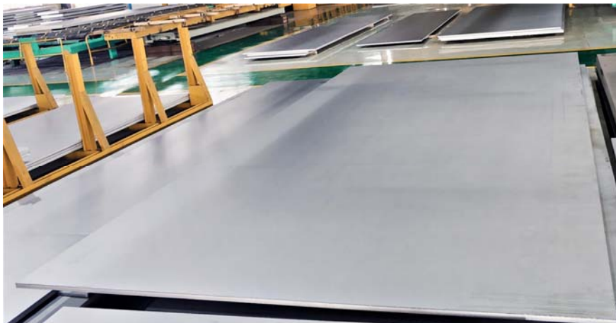
写真1：圧延に成功したNAS800Tの25mm厚×3270mm幅広幅プレート
