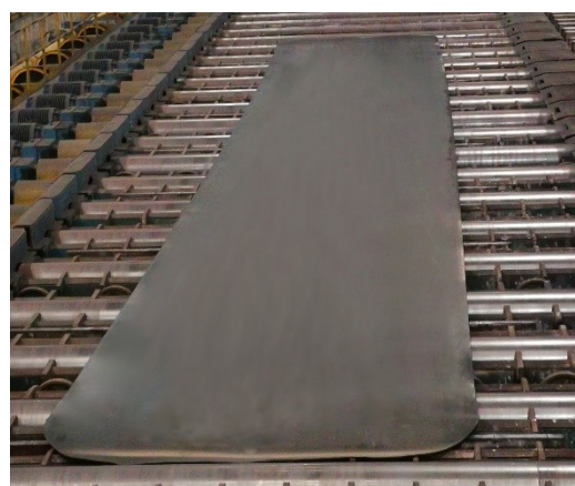
写真2 NAS355N 超広幅プレート 10mm×2500mm×16000mm
