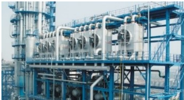
図 石油精製設備用プレート式熱交換器の使用例
