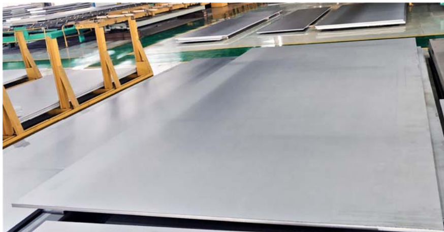
图 1. 成功生产的 25mm 厚×3270mm 宽×7200mm 长的 NAS800T 中厚板
