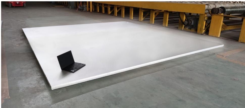
NAS NW276 世界上最大的超宽幅板 3,900×5,000×50 mm
