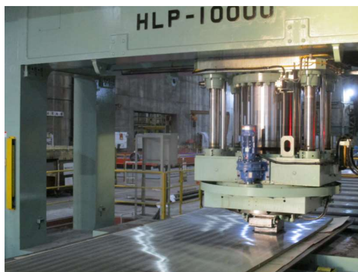
冲压设备（通过液压机矫直、平整板材）
