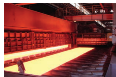
厚钢板用退火炉
