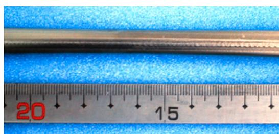
NAS H840等离子焊管30%拉伸试验
