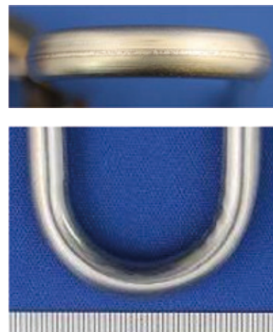
③180° 曲げ試験 (R=14mm)
