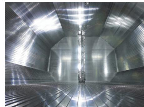
低熱膨張合金の使用例 (LNGタンカータンクの内張り)
