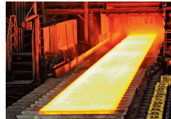
熱間圧延 (NCHミル) での圧延イメージ
