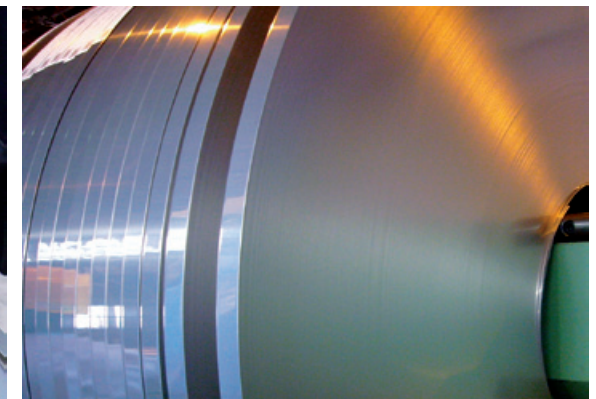
切断された板はコイル状に巻き取られます
