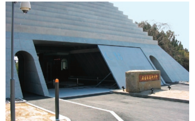
写真③ 電動門扉が水平になるまで倒れると床面に変身
