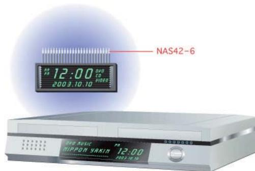
ビデオや自動車のパネル面で時間や速度を表示する蛍光表示管は、ガラス基盤と金属電極を貼り合わせて作られています。このため、ガラスと熱膨張係数が近い金属を用いなければ、ガラスと金属の界面で割れてしまいます。NAS42-6は、室温から高温までガラスの熱膨張係数と極めて類似している特長を生かし、蛍光表示管のリードに使われています。
