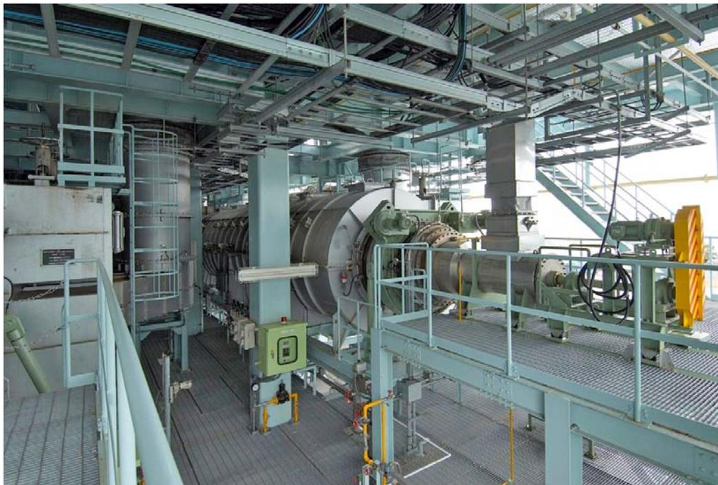
・炭素や水素を含む廃棄物を炭化、ガス化させ、そのガスを発電所に再利用しようという取り組みが進んでいます。その廃棄物焼却用キルンの胴体部分に耐熱性に優れたN800Hが使用されています。
