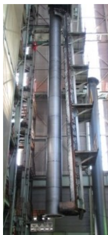
図 NAS600 製縦型光輝焼鈍炉外観(左)および実証試験における炉体の伸び変形挙動(右)
